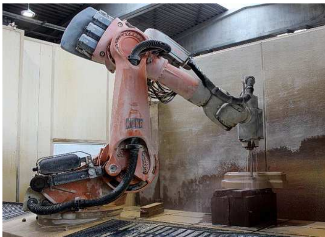
Frézovací robot v Bamberger Natursteinwerk, Bamberg
