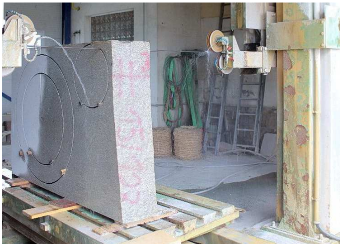
Profilová lanová vyřezávačka, provozovna Kámen Ostroměř
